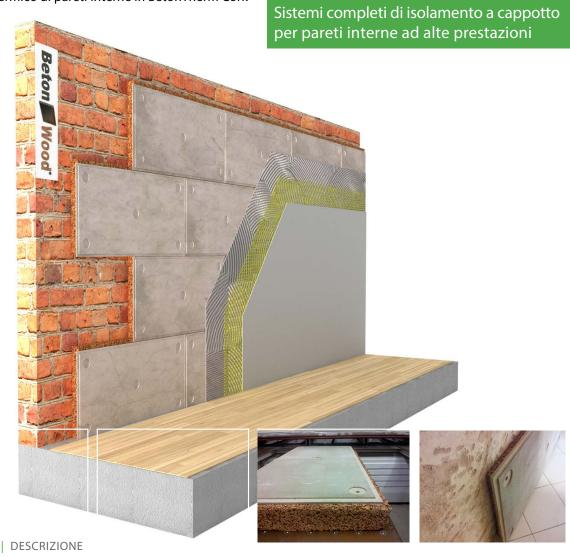
Il sistema completo di isolamento naturale a cappotto corazzato per pareti interne ad alte prestazioni Isolamento a cappotto termico BetonTherm Cork garantisce il massimo comfort e la massima durabilità nel tempo, con la certificazione internazionale ETA.
