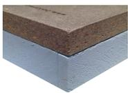
**BetonStyr XPS** Il pannello isolante rigido BetonStyr XPS in cementolegno e polistirene estruso accoppiati è costituito da due strati accoppiati in fabbrica: un pannello in cemento-legno BetonWood ad alta densità ( $1350 \text{ Kg/m}^3$ ) ed elevatissima resistenza a compressione (9.000,00 Kpa) realizzato in conglomerato cementizio tipo Portland e fibra di legno di Pino scortecciato, e uno strato costituito da un pannello in polistirene estruso.
