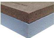
**BetonStyr XPS** Il pannello isolante rigido BetonStyr XPS in cementolegno e polistirene estruso accoppiati è costituito da due strati accoppiati in fabbrica: un pannello in cementolegno BetonWood ad alta densità (1350 Kg/m<sup>3</sup>) ed elevatissima resistenza a compressione (9.000,00 Kpa) realizzato in conglomerato cementizio tipo Portland e fibra di legno di Pino scortecciato, e uno strato costituito da un pannello in polistirene estruso.
