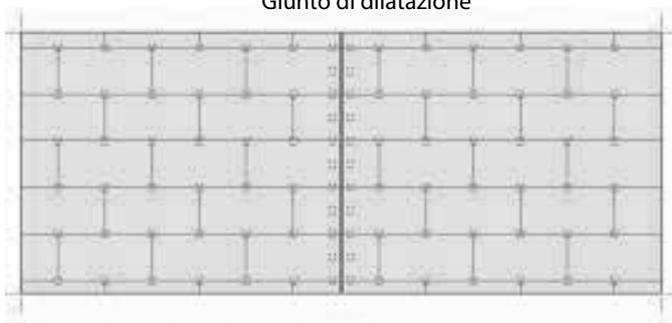
Collocazione di un giunto di dilatazione con posizione dei supporti (interasse 30 cm)
