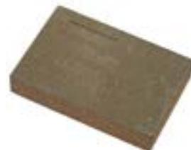
Pannello in cemento legno densità 1350 kg/m³ | Conduttività termica dichiarata  $\lambda_D$ [W/(m\*k)] 0,26 | Calore specifico c 1.880 J/kg K
