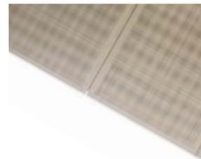
Pannello in cemento legno densità 1350 kg/m<sup>3</sup> | Conduttività termica dichiarata  $\lambda_b$ [W/(m\*k)] 0,26 | Calore specifico c 1.880 J/kg K
