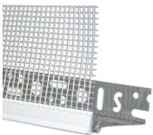
**BetonDripStarter PVC** Profilo di partenza in pvc con rete termosaldata in fibra di vetro 165 gr/mq certificata ETAG004. Collegamento a tenuta tra la base di partenza e la rasatura armata. Interrompe lo scorrimento dell'acqua evitando infiltrazioni. Impedisce le fessurazioni nella zona di zoccolatura. Dimensioni 2,5x0,125 m. 25 pezzi per confezione.
