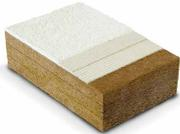
**FiberTherm Protect dry** Pannello in fibra di legno intonacabile disponibile nelle densità 110-140-180 Kg/m<sup>3</sup> con un'elevata resistenza a compressione e idrorepellente per la realizzazione di cappotti termici certificati. Conduttività termica dichiarata  $\lambda_D$  [W/(m\*k)] 0,037÷0,043. Disponibile nei formati: 2.800x1.250 mm, 2.600x1.250 mm, 1.350x600mm, 1.200x400 mm. Spessori da 40 a 240 mm.
