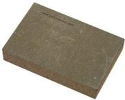
**BetonWood N** Il pannello BetonWood, ad alta densità ( $1350 \text{ Kg/m}^3$ ), è realizzato in conglomerato cementizio tipo Portland e fibra di legno di Pino scortecciato. Ha le seguenti caratteristiche termodinamiche: coefficiente di conduttività termica  $\lambda=0,26 \text{ W/mK}$ , calore specifico  $c=1,88 \text{ KJ/Kg K}$ , coefficiente di resistenza alla penetrazione del vapore  $\mu=22,6$  e classe di reazione al fuoco A2-fl-s1, secondo la norma EN 13501-1.
