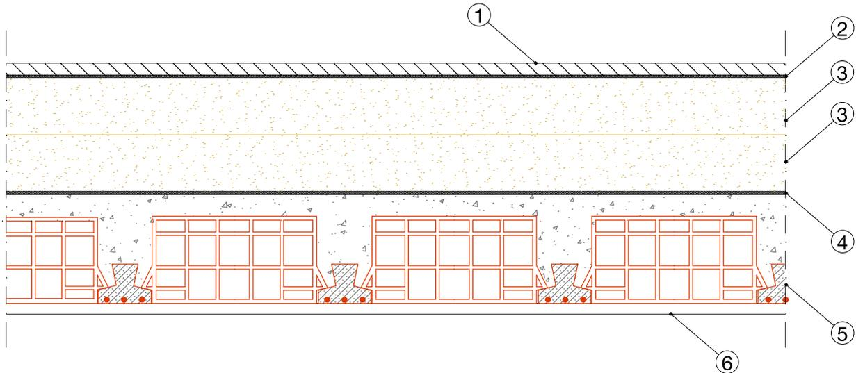
1. **Pannello in cementolegno BetonWood** è realizzato in cementolegno Portland e fibre di legno, ha densità  $1350 \text{ kg/m}^3$  ed una elevatissima resistenza a compressione pari a  $9.000,00 \text{ Kpa}$ . Questo particolare pannello garantisce un'ottima soluzione per interventi mirati ad ottenere alti livelli di sfasamento termico, grazie alla sua alta densità che lo rende adatto anche per massetti a secco autoportanti, pavimenti radianti e strutture di irrigidimento.
