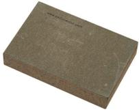
**BetonWood** Il pannello è realizzato in conglomerato cementizio tipo Portland e fibra di legno di Pino scortecciato, ad alta densità ( $\delta=1350 \text{ Kg/m}^3$ ) e con le seguenti caratteristiche termodinamiche: coefficiente di conduttività termica  $\lambda=0,26 \text{ W/mK}$ , calore specifico  $c=1,88 \text{ KJ/Kg K}$ , coefficiente di resistenza alla penetrazione del vapore  $\mu=22,6$  e classe di reazione al fuoco A2-fl-s1, secondo la norma EN 13501-1.
