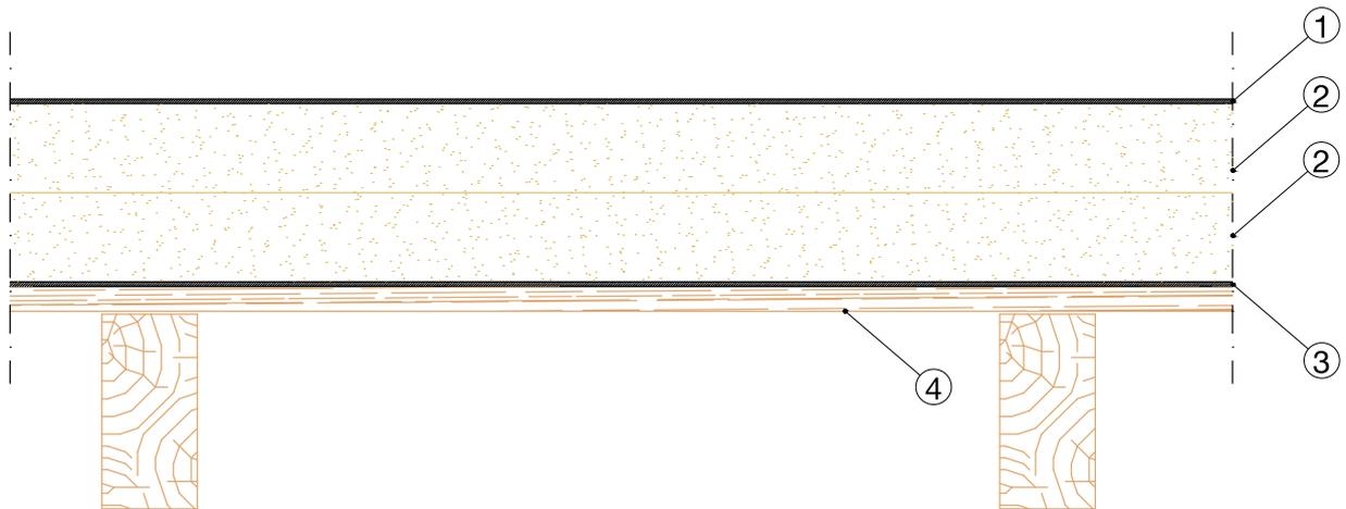
1. **Barriera antivapore FiberTherm multi UDB** Membrana sigillante in polipropilene (PP) multi-strato non-tessuto ad alta traspirabilità ed ottima resistenza allo strappo. Densità 160 g / m<sup>2</sup>
